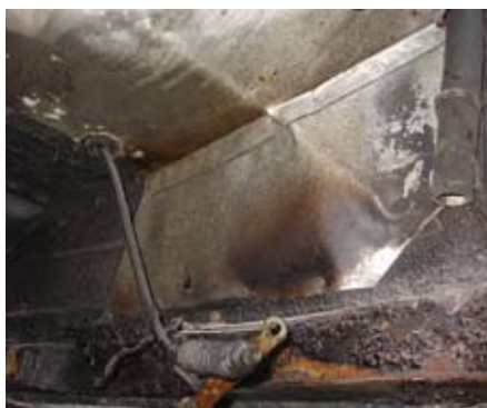
De cardantunnel met daarin een hitte-schild. De rubber slang is de afwatering van de bak onder de voorruit. Motorolie en andere vettigheid hebben roest tegen-gewerkt.
