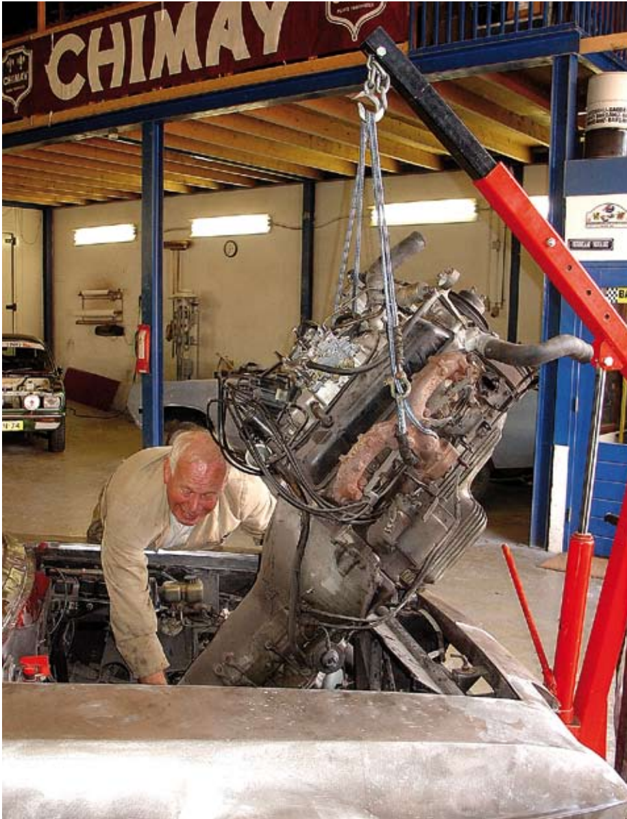
De takel kan niet verder hijsen. Het blok met de versnellingsbak over het front getild worden. Nee Benno, dit is te zwaar voor jou! (Zie openingsfoto bij dit artikel hoe het wel lukte.)
