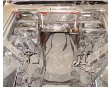
Het motorcompartiment helemaal kaal. Zelfs de laklagen zijn er naar wat uurtjes schuren en borstelen afgehaald. Gelukkig openbaren zich geen gekke dingen.
