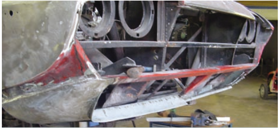
9. Rechtsvoor is de onderzijde van de neus voorzien van het op maat gemaakte stuk profiel.
