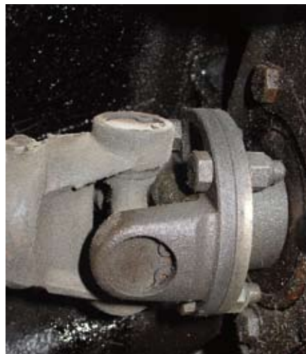
De cardanas zit muurvast aan het differentieel. Met een simpel ratelsetje bereik je hier niks.
