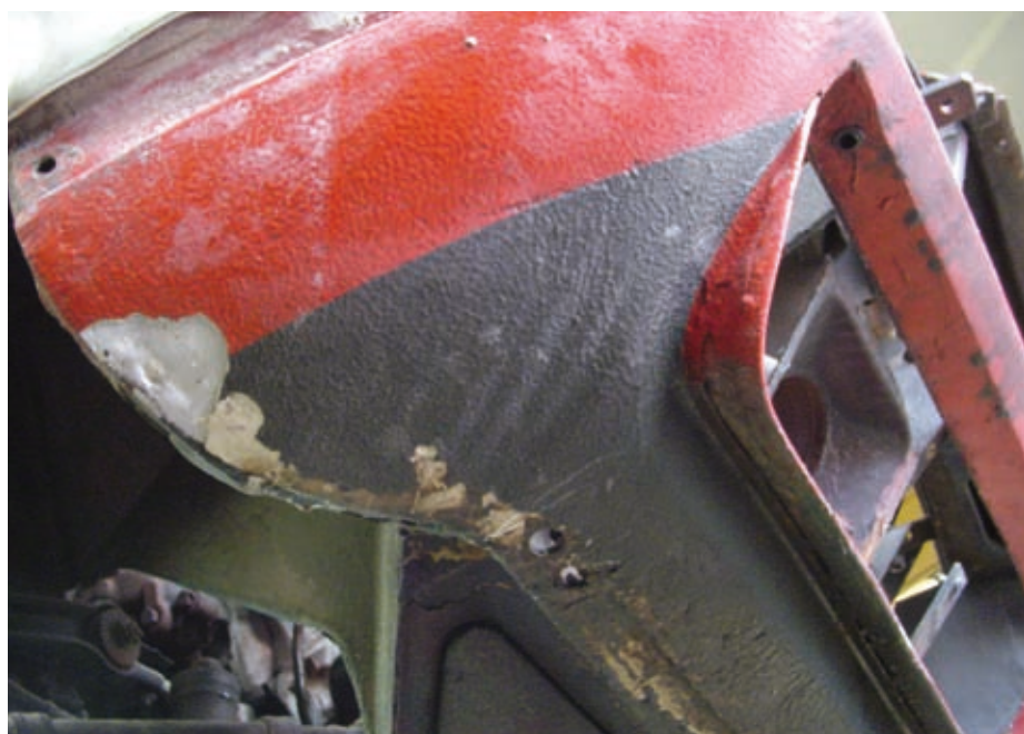
2. De neus van de Lele, rechtsvoor aan de onderzijde. Een stuk plamuur is er al afgespat.
