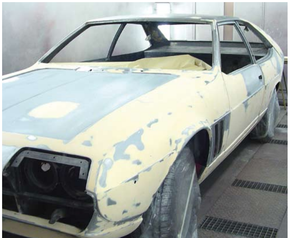
Lele is na het opvullen van haar rimpels en andere oneffenheden glad gestreken - oftewel uitgeschuurd - en klaar voor de verjongingskuur - oftewel spuitplamuur en grondverf.
