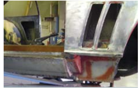
8. De buitendorpel zit er voor het grootste deel tegenaan gelast. Ook hier is geen gebruik gemaakt van het streeplassen maar van het proplassen.
