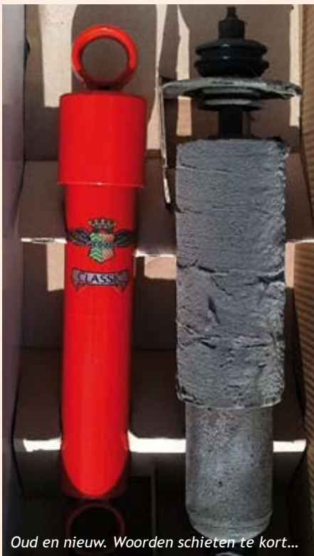
De body en de stofkappen met ogen zijn gepoedercoat in klassieke Koni-kleur.
