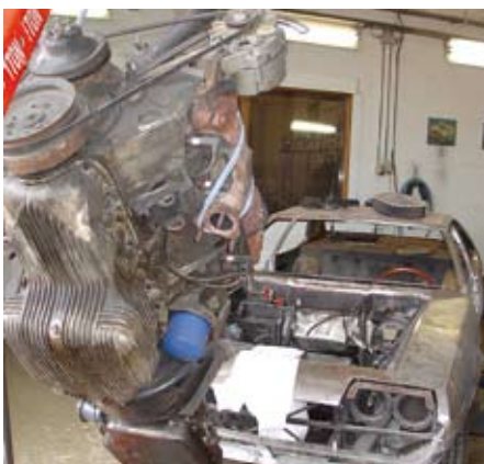
Acht cilinders met 5,3 liter inhoud plus automatische versnellingsbak schoon aan de haak. Machtig!
