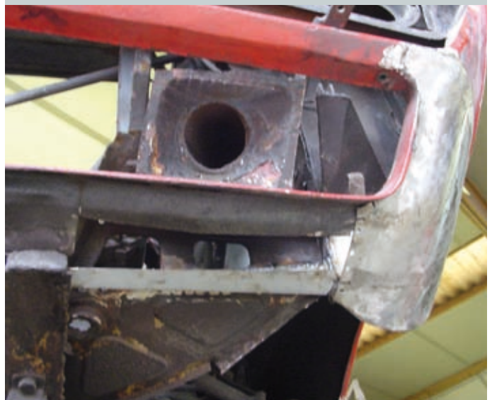
7. De zijkant van de neus heeft een nieuw stuk plaatwerk gekregen. Nu de zijkanten zijn vernieuwd, wordt begonnen met de onderzijde van de neus; hier is al een deel weggeslepen. Vanaf de zijkanten wordt dus naar het midden toegewerkt.
