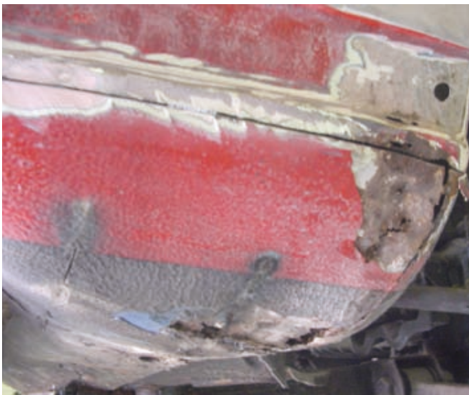
4. De neus linksvoor aan de onderzijde. Nog slechter dan rechts.
