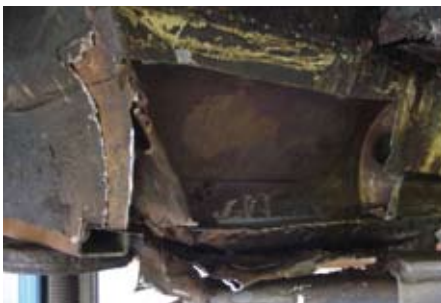
12. Oeioei!!! Als ook de binnendorpel wordt verwijderd, is duidelijk zichtbaar dat er in het verleden doodleuk reparatiestukken tegenaan zijn gelast.
