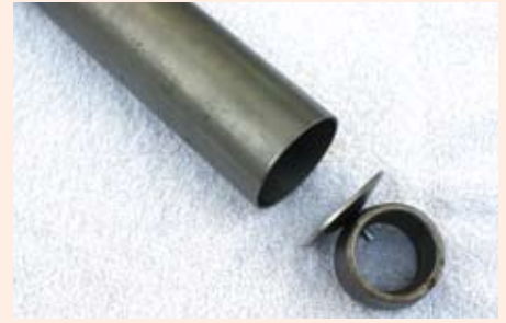
De body van de demper met het nog te bevestigen oog waarmee het aan de wielophanging bevestigd wordt.
