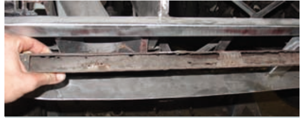
11. Onder het oude kokerprofiel gezien aan de achterzijde, er boven de nieuwe op maat gemaakt.
