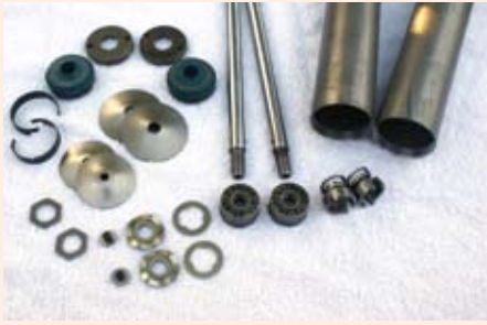
De losse onderdelen die het inwendige vormen van de schokdemper. Gemaakt met zeer nauwe toleranties.
