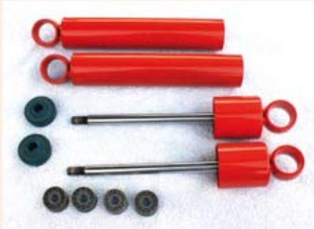
De body en de stofkappen met ogen zijn gepoedercoat in klassieke Koni-kleur.
