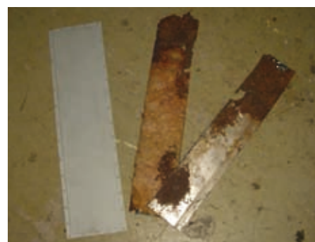
Boven de achterste uitlaatdempers zit hittebestendig materiaal als in een wafel tussen twee stroken metaal. Deze is compleet vervangen. Links is de nieuwe strook metaal te zien.
