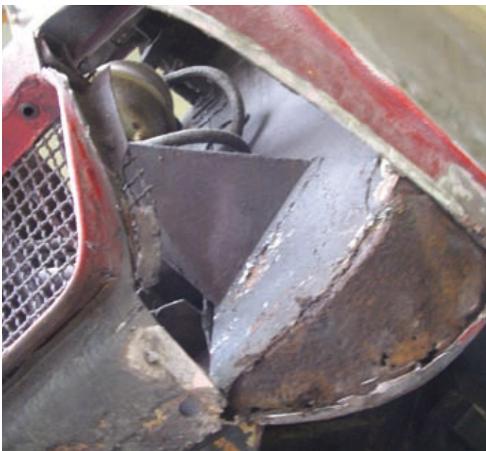
6. Het rotte stuk is eruit geslepen en je ziet, er verschuilt nog meer roest achter... zoals gebruikelijk.
