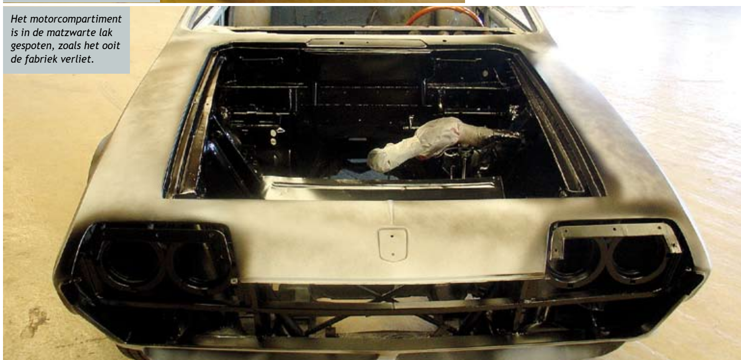
De grondverf is aangebracht en tevens is lichtjes een zwarte lak over de carrosserie gespoten waardoor oneffenheden en onregelmatigheden zich duidelijker manifesteren. Deze dienen er dus nog uitgeschuurd te worden.
