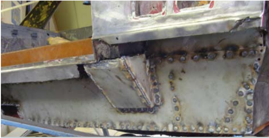
7. De versterking onder de A-stijl wordt weer in ere hersteld. Op foto 2 is te zien wat er nog van over was. Nu beter en steviger dan toen de Lele de fabriek verliet.
