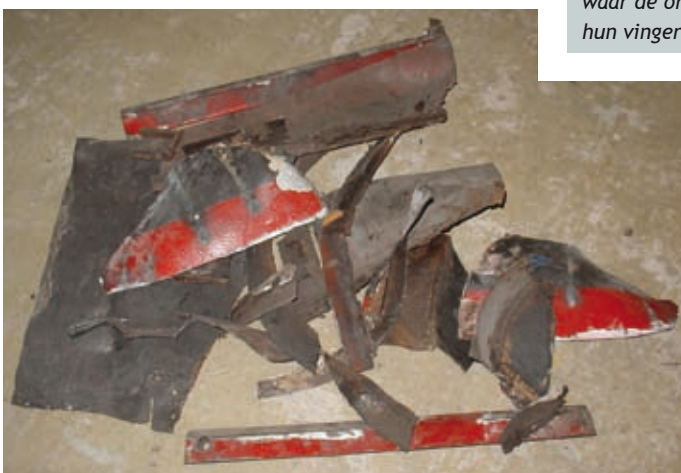
14. Dit en nog veel meer blijft over nadat de slijptol in de neus is gezet.
