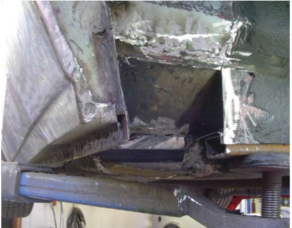
Het chassis is erg degelijk qua constructie. Dit blijkt ook uit deze doorsnede. Hier moet een nieuw stuk gezet worden in een driehoekvormige 'balk' die over de volle wagenbreedte loopt, achter de voorwielen. Tevens een nieuw stukje plaat in het voetencompartiment (gat in bodem, midden onderin foto). De plaatdikte is hier 1,5 mm, omdat dit in verbinding staat met de kriksteun.
