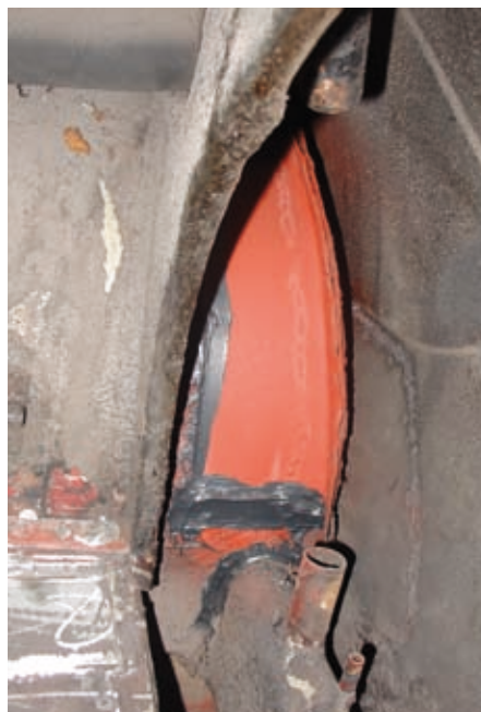
De wielkast perfect gerepareerd met de lasnaden al gekit!
