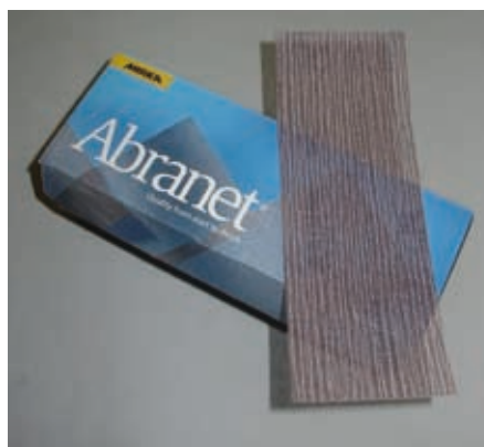
Een revolutionair schuurmateriaal: Mirka Abranet. Het bestaat uit aluminiumoxide korrels op een nylon net en heeft duizenden gaatjes waardoor het stof er niet in blijft vastzitten.
