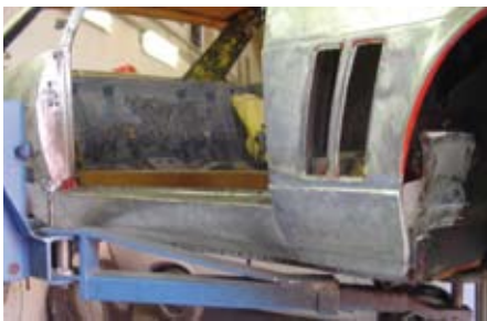
9. De rechter dorpel weer netjes dicht. Tevens is het nieuwe stuk in de wielkast zichtbaar. Het opsplattend vuil had door de jaren heen zijn vernietigende werking gedaan en dus... nieuw stukkie erin!
