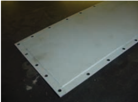
Origineel bezit het plaatwerk van 'de wafel' een gezette rand, die er uiteraard weer bij het nieuwe stuk plaat in aangebracht wordt.
