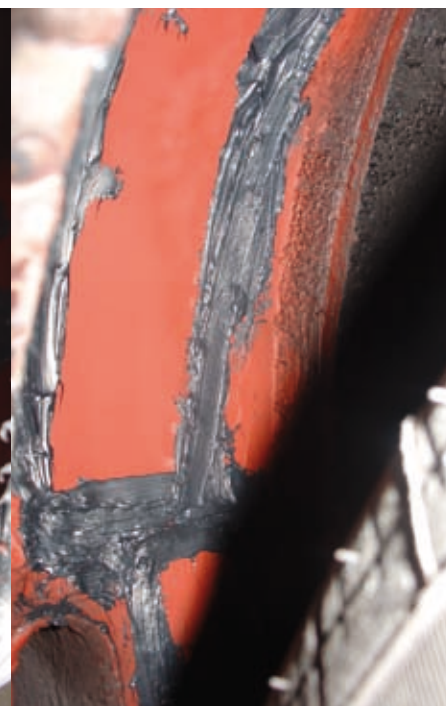
Nieuw plaatwerk in de wielkasten gelast, in de primer en met afgekitte lasnaden.
