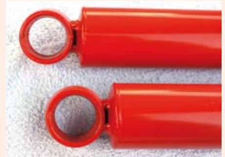
Hier wordt TIG-lassen toegepast in plaats van MIG, waardoor de lasproppen kleiner worden
