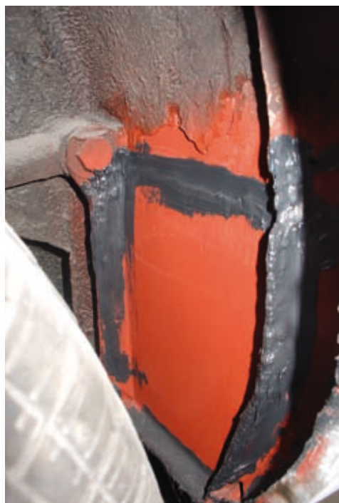
Nieuw plaatwerk in de wielkasten gelast, in de primer en met afgekitte lasnaden.
