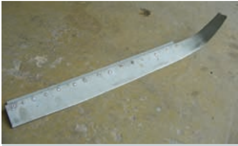
8. Profielen die in de neus verwerkt moeten worden, dienen stuk voor stuk op maat gemaakt te worden. Er zijn geen tekeningen voorhanden en er is geen nieuw stukje te koop bij de automaterialenhandel of op het Internet.
