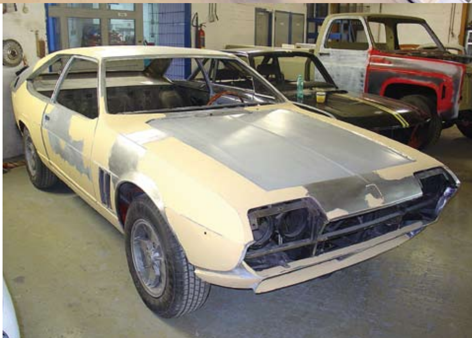
Lele in de plamuur. Zowel de grijze staalplamuur als de gele polyester plamuur is aangebracht. Op de achtergrond nog zichtbaar, het avondmaal van een noeste klassiekerhobbyist: flesje water en magnetronsoepje.
