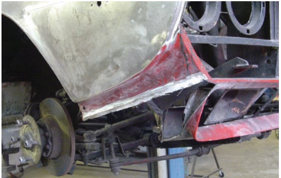
3. Het slechte deel is rechtsvoor eruit gehaald en wordt als mal gebruikt voor een nieuw stukje plaat.
