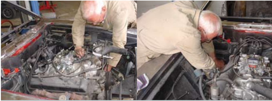
Alle leidingen en kabels van het motorblok die een verbinding maken met de carrosserie worden losgemaakt. Het luchtfilter is hier al verwijderd om meer bewegingsvrijheid te creëren.
