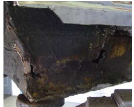
11. De linker dorpel... ziet er niet beter uit dan de rechter. Zelfs de binnendorpel is doorgeroest.
