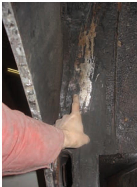
De wielkast rechtsachter. Na het verwijderen van de tectyl - met föhn en krabber - is duidelijk zichtbaar dat er metaalmoleculen hebben losgelaten.
