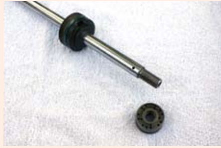
De demperstang, inductiegehard. Het deel van de stang dat in de body blijft, is voorzien van een voorgeschreven gaatjespatroon waar doorheen olie loopt.
