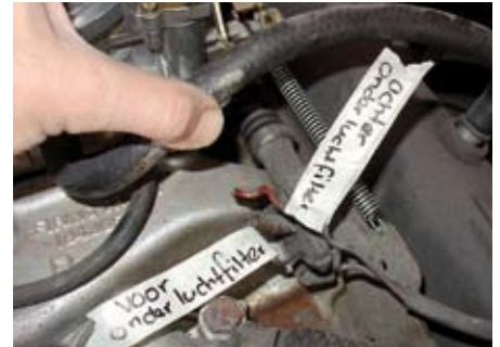
Labellen van losgehaalde leidingen en kabels is essentieel om het later weer op de juiste plaats vast te kunnen maken.
