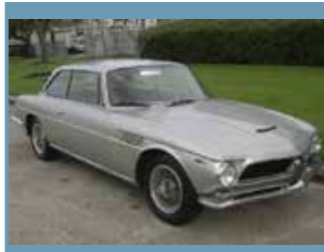
Iso Rivolta 300, das erste GT-Modell der Marke (1962–1970): Chevrolet-V8 (5,3 Liter, bis 340 PS), De-Dion-Hinterachse, Bertone-Design
