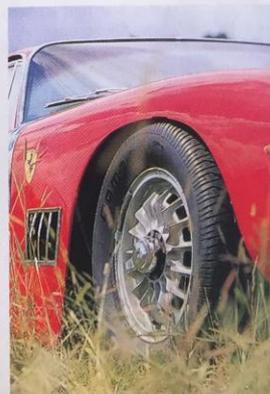
Die Felgen haben Zentralverschluss. Die zuvor montierten überbreiten Reifen hatten den Radlauf leicht beschädigt
