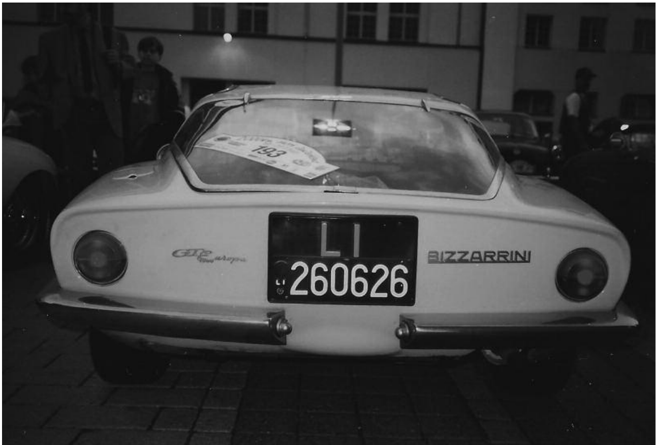
Der Blick auf das Heck zeigt, wie niedrig der GT Europa ist: nur 104 cm!
